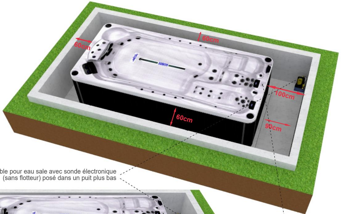
pompe submersible pour eau sale avec sonde électronique (sans flotteur) posé dans un puit plus bas
